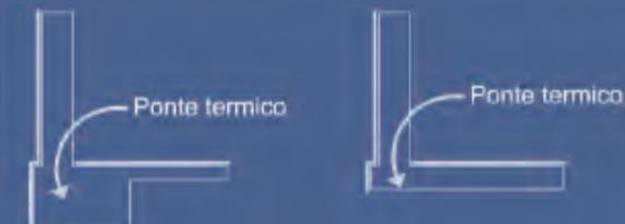
Isolamento sul plinto di fondazione o sulle fondamenta.
